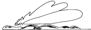
Fig. 1 - Le direttive hanno oltre al lobo principale, altri lobi secondari più o meno ampi. In verticale: il lobo principale può guardare all'orizzonte, ma difficilmente si ha una buona irradiazione con angolo zero, per effetto delle cancellazioni da parte del terreno. Vi sono lobi con angoli più elevati, che dovrebbero essere ridotti al minimo, perché si tratta d'energia perduta agli effetti della comunicazione fra due punti terrestri. Il sole è forse la fonte più attendibile per la messa a punto delle antenne perché consente di rilevare i lobi secondari, se importanti.
