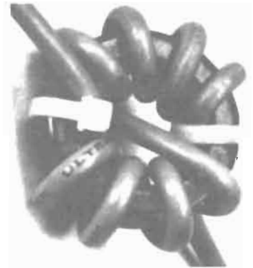
Fig. 1 - Cordini di altoparlanti, cordini luce, cavetti multipli acquistano sufficiente induttanza da bloccare la uscita e l'ingresso della a.f. se avvolti come vedesi nella foto su un toroide di ferrite (Amidon FT-140-61: sono sufficienti da 6 ad 9 spire).
